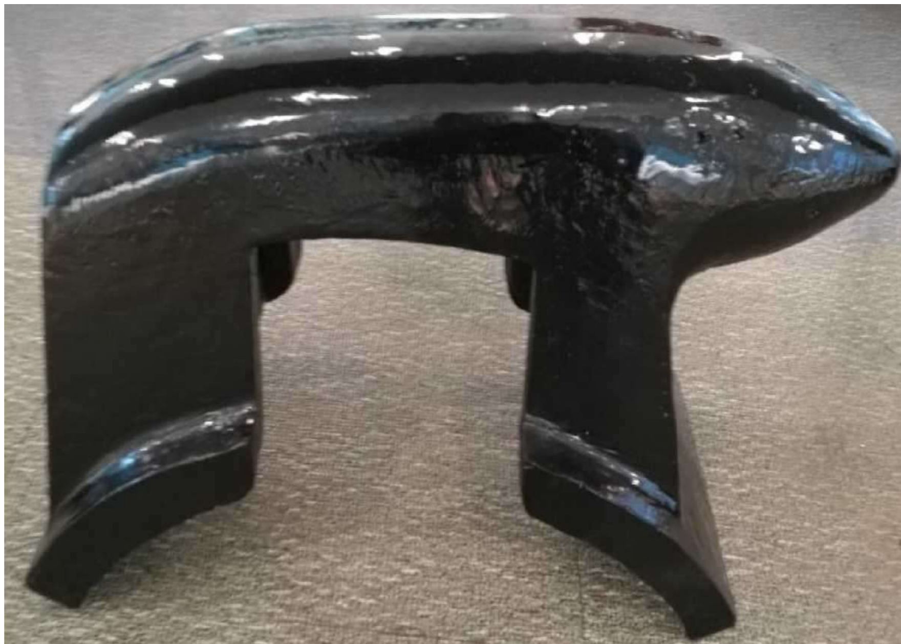
Замена подвижных зубьев седлового типа MMD1000
