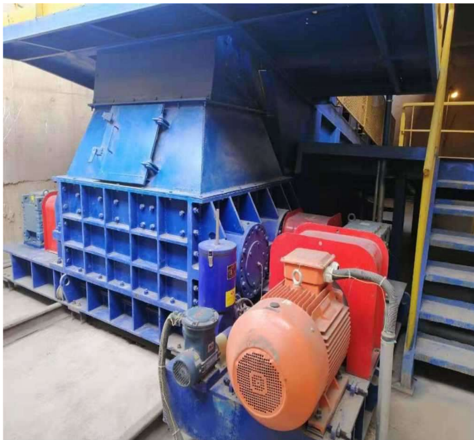
Цементный завод Lifeng | Дробилка глины 240 т/ч
