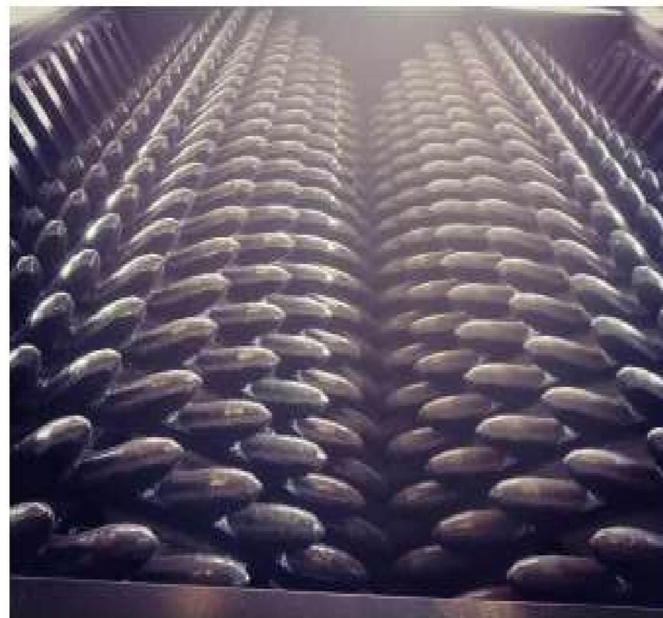
Пакистанская угольная электростанция Thar TEL Дробилка для бурого угля 450 т/ч
