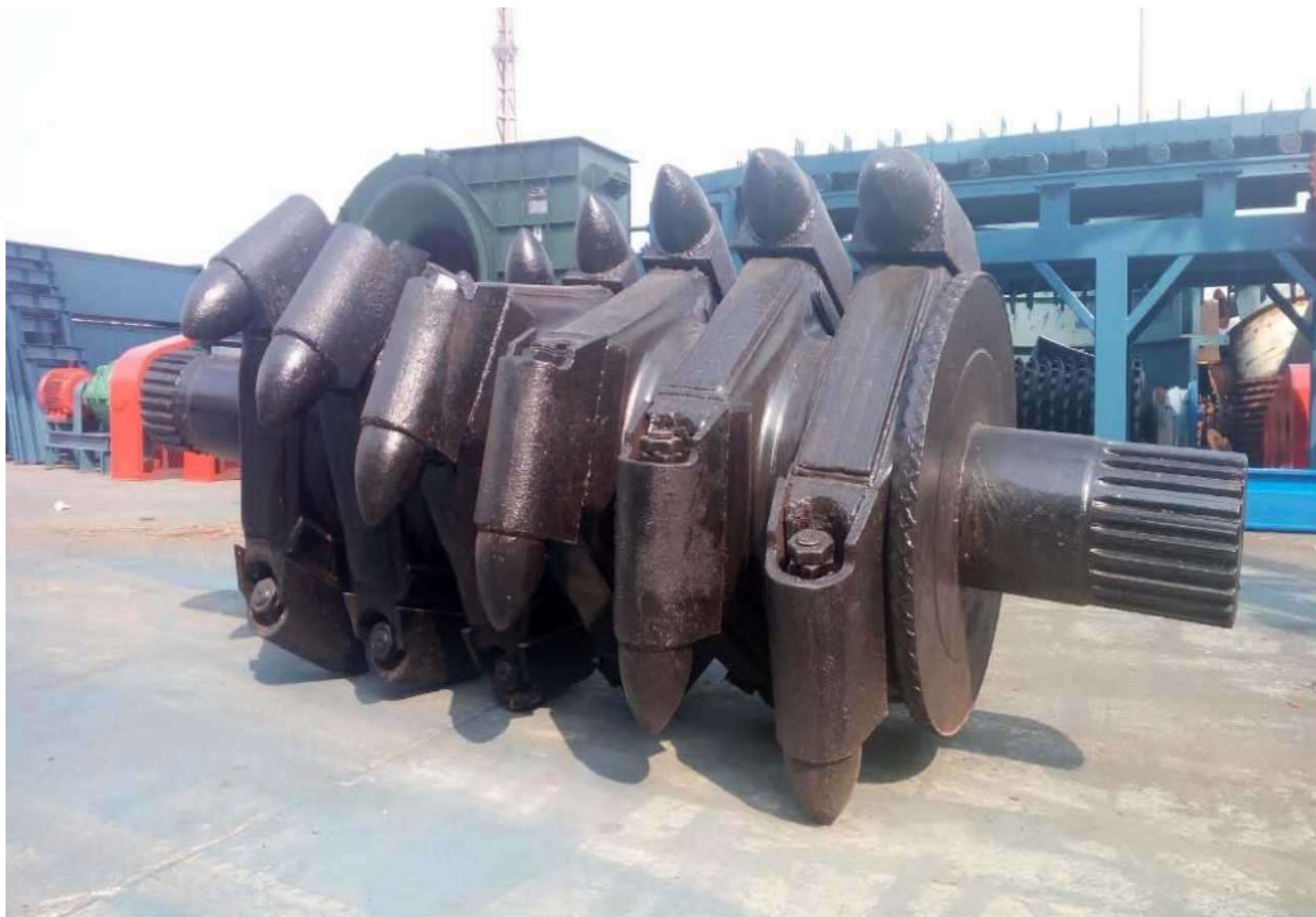
Замена валка дробилки серии MMD1500
