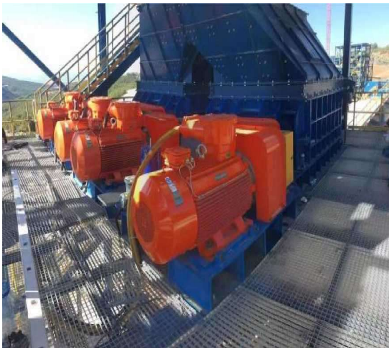
Турция FIBA GROUP | дробилка рядового угля 800т/ч
