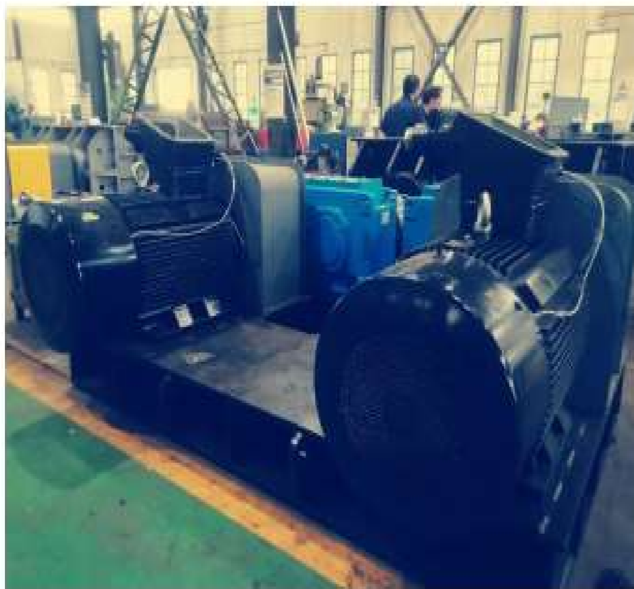
Пакистанская угольная электростанция Thar TEL Дробилка для бурого угля 450 т/ч
